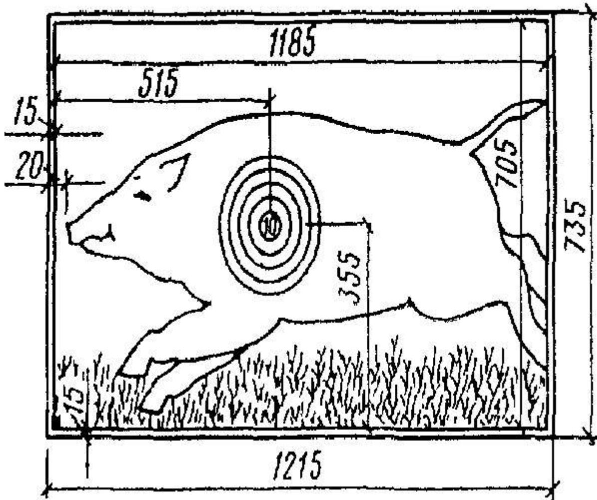
Рис. 11. Движущиеся мишени (размеры, мм)
