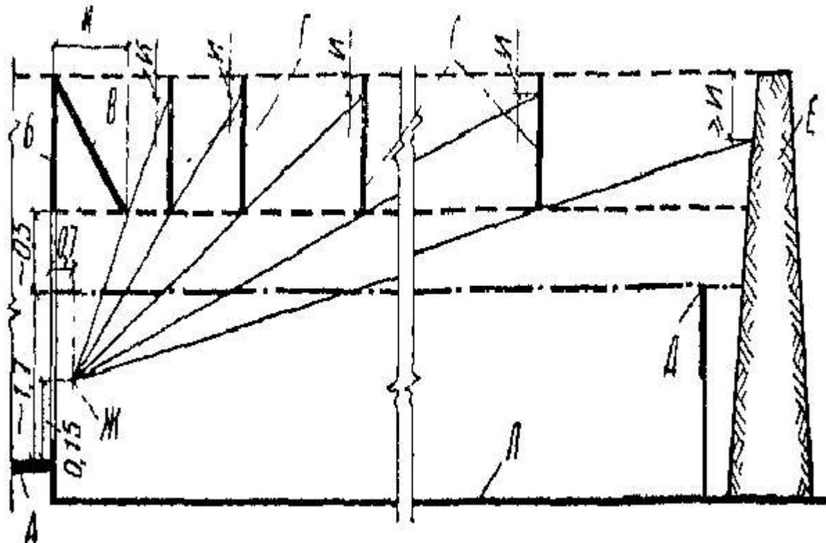
**Рис. 7. Схема графического определения размеров, местоположения и количества поперечных перехватов в огневой зоне полузакрытого тира (размеры, м)**
