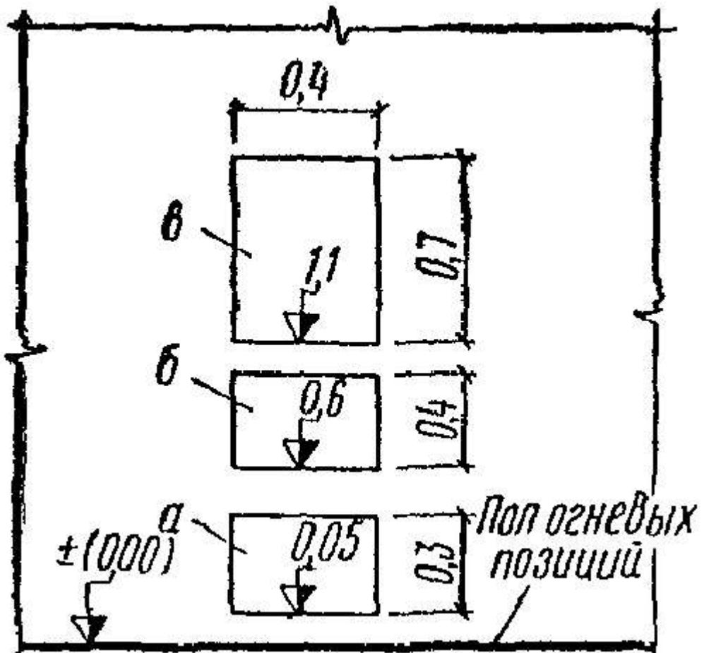
Рис. 6. Схема расположения и габариты бойниц (размеры, м)
