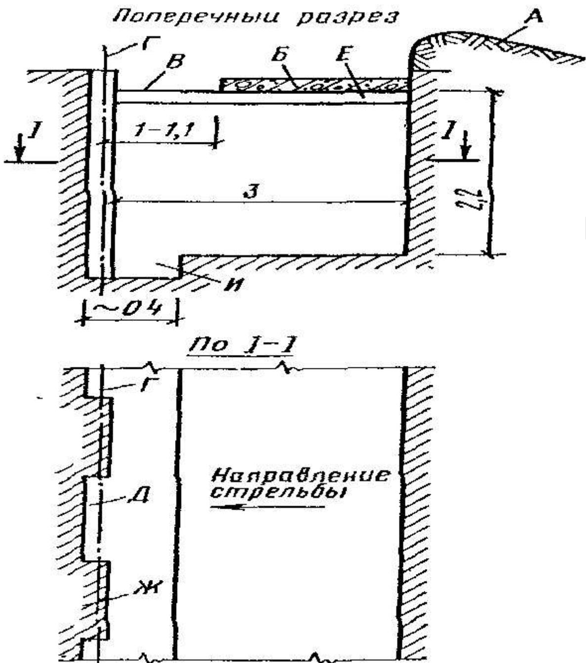
Рис. 13. Заглубленный блиндаж в тирах для стрельбы по мишеням с черным кругом и по силуэтным мишеням (размеры, м)
