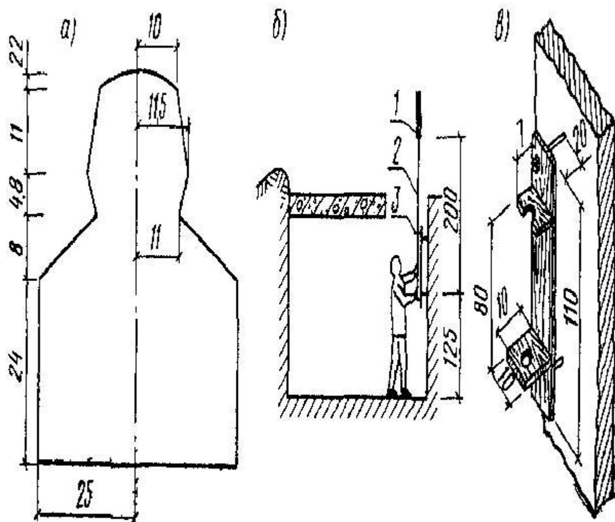
**Рис. 12. Мишенная установка для "дュэльной" стрельбы (размеры, см)**
