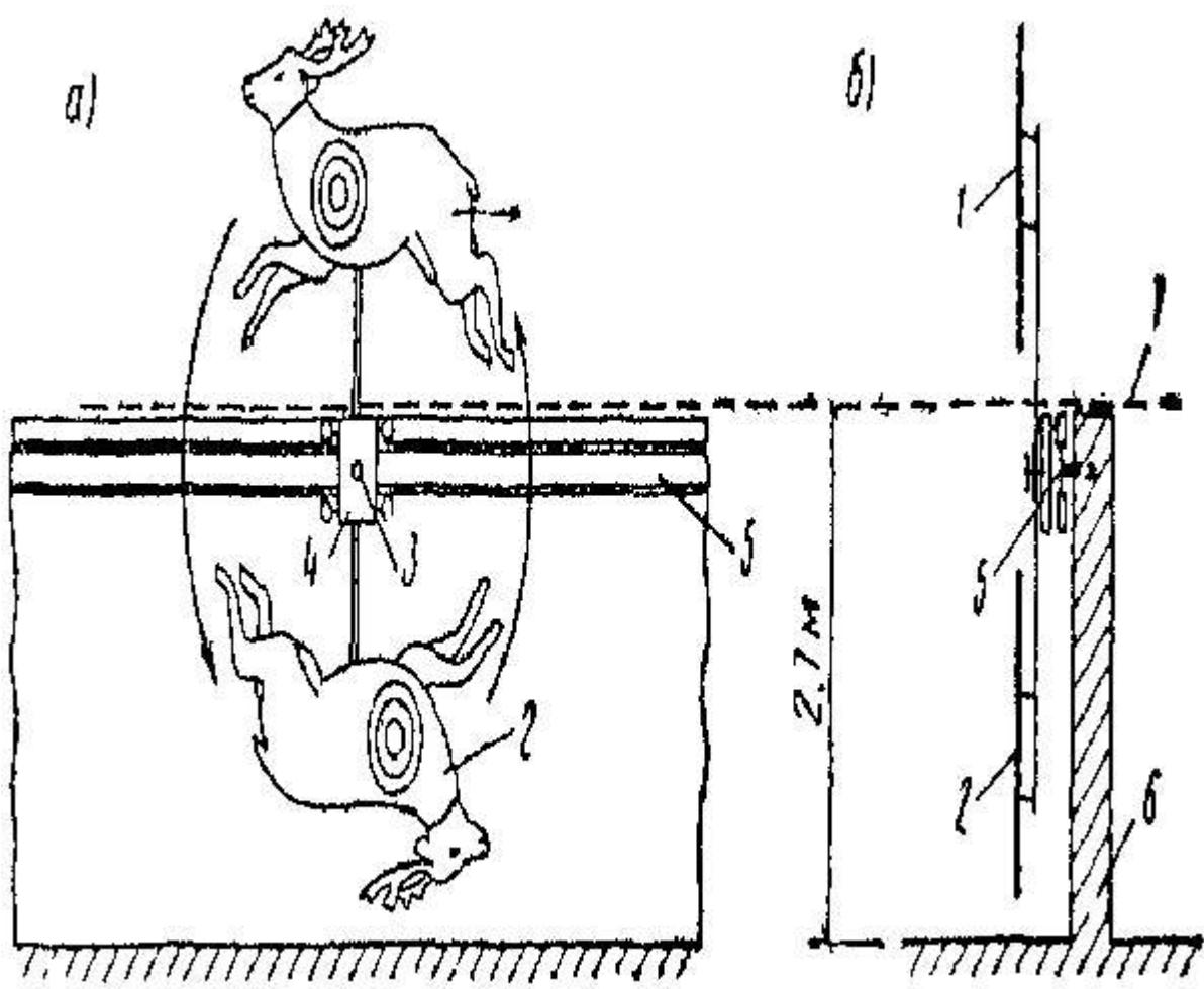
Рис. 10. Схема устройства мишенной установки "бегущий олень"
